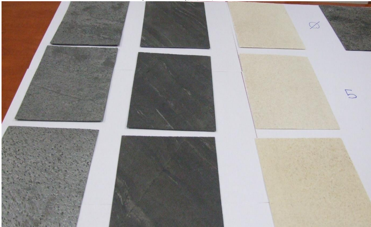
3. ábra. A nem impregnált minták UV Kezelés után (0, 5 és 10 év fentről lefelé)
